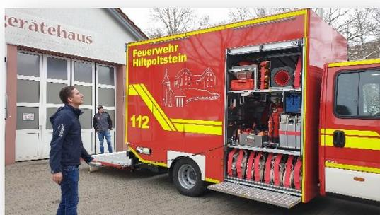
im hinteren Bereich des Aufbaus. Dieser bietet Platz für vier Rollcontainer, die mit verschiedensten Inhalten bestückt werden können und die somit auch für unterschiedliche Aufgaben eingesetzt werden können. Neben dem Vorhalten einfacher Gerätschaften zum Absichern und Säubern bei Unfällen auf der Bundesstraße können damit auch die gebrauchten Pressluftatmer der Atemschutztrupps
